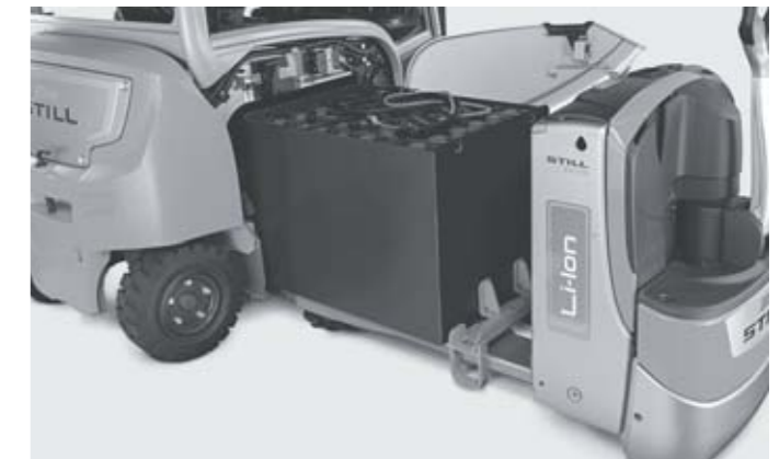
Batteriewechsel mit Elektrohubwagen
